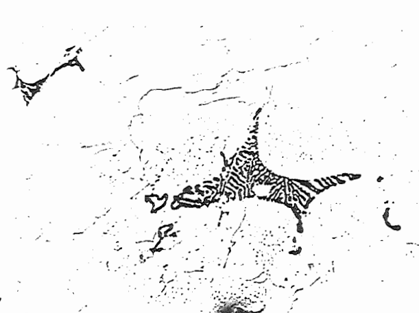
Figura 6 - Liga IIIA tratada termicamente. Carbonetos eutéticos do tipo M_7C_3 em matriz predominantemente martensítica com carbonetos secundários precipitados.
