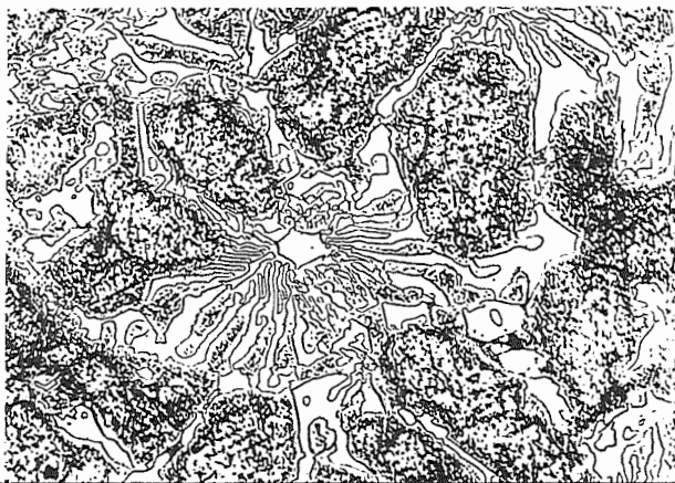
Figura 4 - Liga IIB tratada termicamente. Carbonetos eutéticos do tipo M_7C_3 em matriz predominantemente martensítica com carbonetos secundários precipitados.
