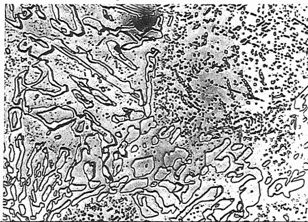
Figura 6 - Liga IIIA tratada termicamente. Carbonetos eutéticos do tipo M_7C_3 em matriz predominantemente martensítica com carbonetos secundários precipitados.
