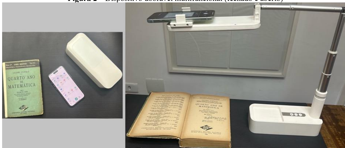
Figura 2 – Dispositivo dobrável multifuncional (fechado e aberto)
