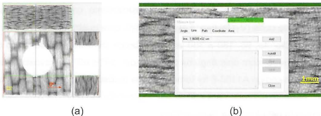
Figura 2 – (a) Posicionamento dos cursores sobre a área danificada. (b) Espessura de dano ( h_d ) avaliada no software CTAn®.
