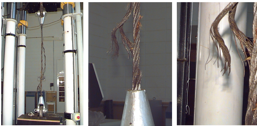
Figura 4.7 - Ruptura do cabo de 1" de diâmetro
