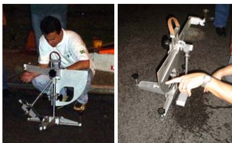
Figura 5: Realização do ensaio de microtextura com o Pêndulo Britânico Fonte: ODA, NASCIMENTO e EDEL (2005).
