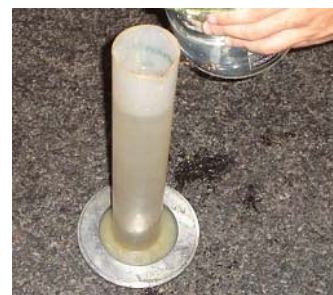
Figura 6: Determinação da permeabilidade
