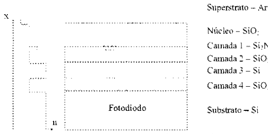
Fig. 4. Estrutura ARROW projetada e analisada
