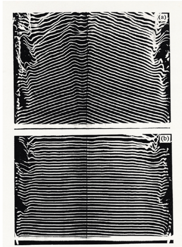
Figura 12: Visualização dos diferentes modos de geração e desprendimento de vórtices: (a) sem controle nas condições de contorno nas bordas do cilindro; (b) com controle nas condições de contorno utilizando placas inclinadas, reproduzida de Williamson, 1991.
