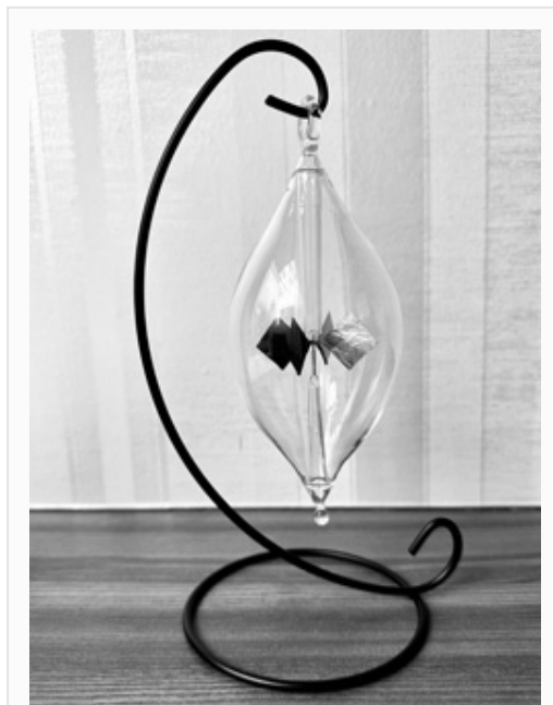
Figura 2 – O moinho de luz ou radiômetro de Crookes. A explicação da causa de seu movimento cativou muitos cientistas, incluindo J. Maxwell e A. Einstein. Várias explicações incorretas foram apresentadas sobre o seu funcionamento e, mesmo hoje em dia, estão ainda presentes como é o caso do verbete “radiometer” da Enciclopédia Britânica
