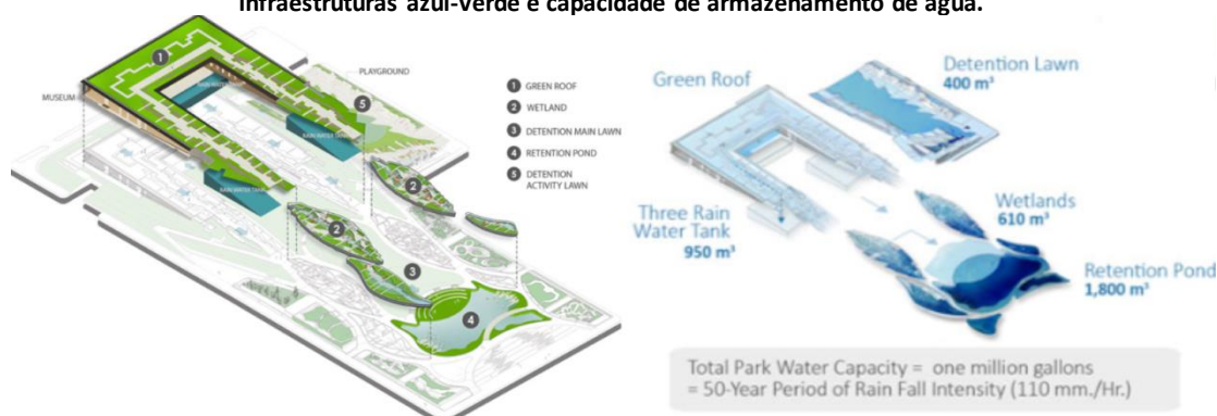
Figura 1 - Projeto do Parque Centenário da Universidade Chulalongkorn, destacando seu conjunto de infraestruturas azul-verde e capacidade de armazenamento de água.
