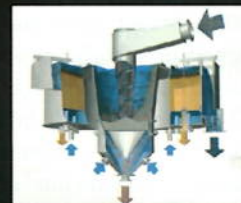
Concentração de finos de minério com ALLFLUX (All Mineral)
