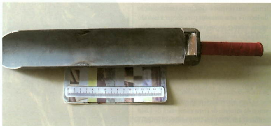
Figura 1 – Pá utilizada para amostragem de pilhas
