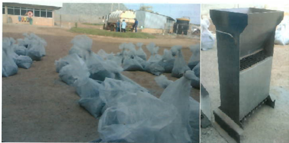
Figura 6 – Quarteador Jones e amostras prontas para análise.
