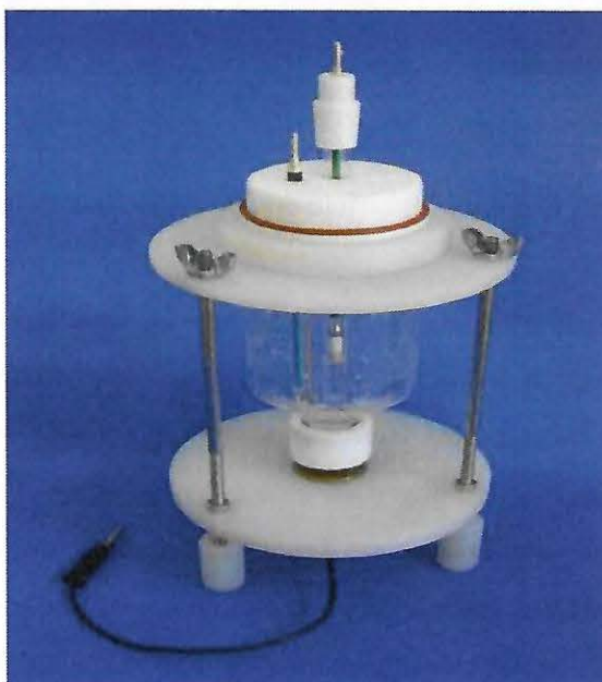
Figura 1 - Célula eletroquímica utilizada nos ensaios de polarização potencioestática.
