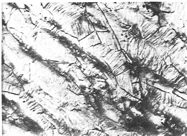
FIGURA 3 - Fotomicrografia da liga 2 no estado solubilizado e deformado 30%; observa-se uma estrutura bastante deformada com precipitados em evidência em toda superfície. 175X.
