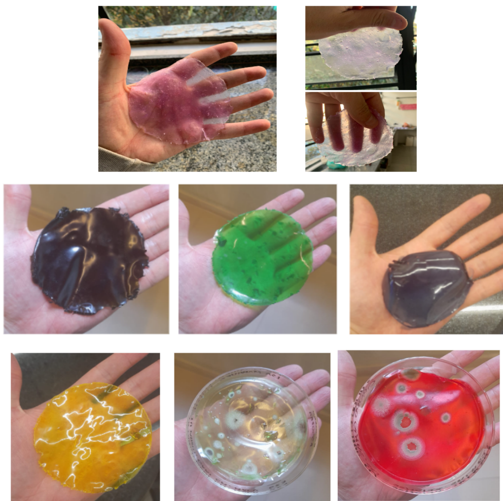
Figura 2. Fotografias dos bioplásticos produzidos: as diferentes consistências, texturas e cores obtidas decorreram da proporção diferencial entre os reagentes utilizados.
