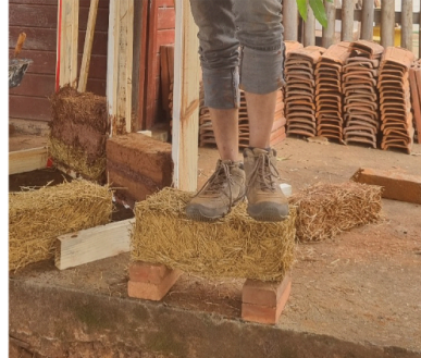
Figura 5: Teste de resistência do bloco de adobillo Fonte: Acervo do grupo Habis
