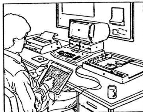
Figura 2 - Estação de trabalho de um microcomputador: 1) impressora gráfica; 2) disquete flexível de 5 1/4"; 3) monitor de vídeo; 4) dois controladores de disquetes; 5) teclado e microcomputador; 6) traçadora de mesa tamanho A3; 7) placa digitalizadora [3]
