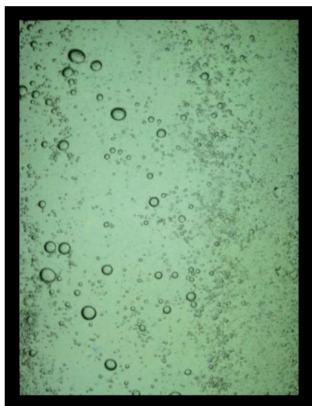
Figura 2a. Bolhas ascendentes (Mibcol, 9 ppm) no medidor APBS (UCT).
