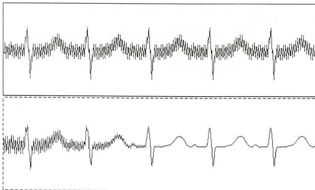
Fig. 3 Canal superior : Sinal cardíaco com interferência de 10 % de 60 Hz. Canal inferior : Saída do filtro com parâmetro de adaptação d=0,70 .
