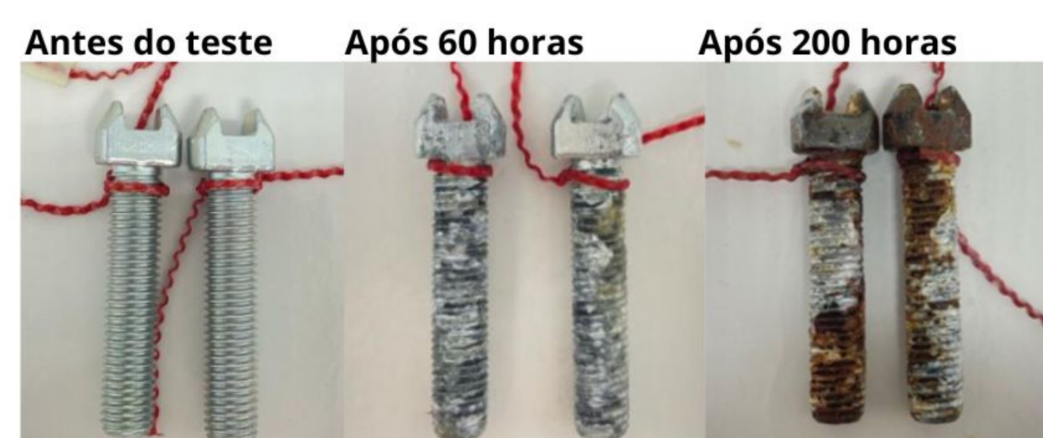
Figura 3. Parafuso em condição inicial e aquecido, após 60 horas e após 200 horas de teste em câmara de salt spray. Fonte: Autora própria.
