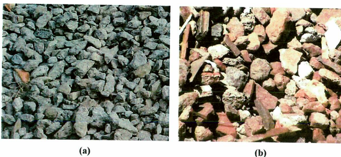
Figura 1 - RCD mineral cinza (a) e vermelho (b) da usina de Itaquera
