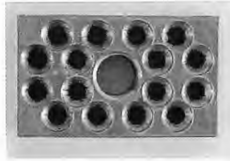
Figura 6 – Base de fixação dos parafusos para ensaios.
