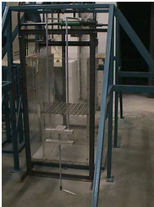
Figura 1 - Tanque com grades oscilantes em funcionamento no Laboratório de Hidráulica Ambiental CRHEA/SHS-EESC-USP.
