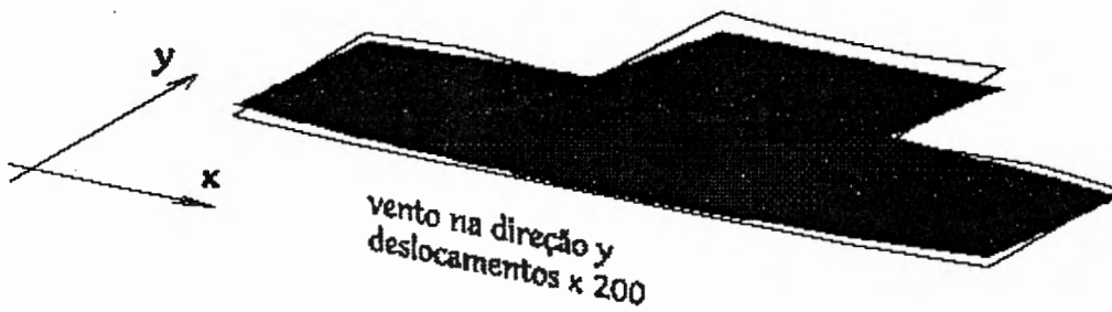
Figura 6: Aspecto da deformada de recalques para vento na direção y.
