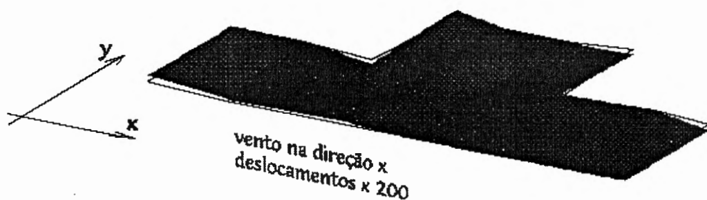
Figura 5: Aspecto da deformada de recalques para vento na direção x.
