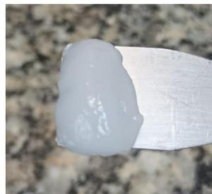
Figura 1: Gel final com 3% de NFC de eucalipto.
