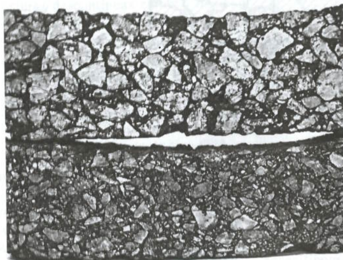
FIGURA 27.6 (a) Corpo de prova de SMA; (b) corpo de prova de concreto asfáltico.
