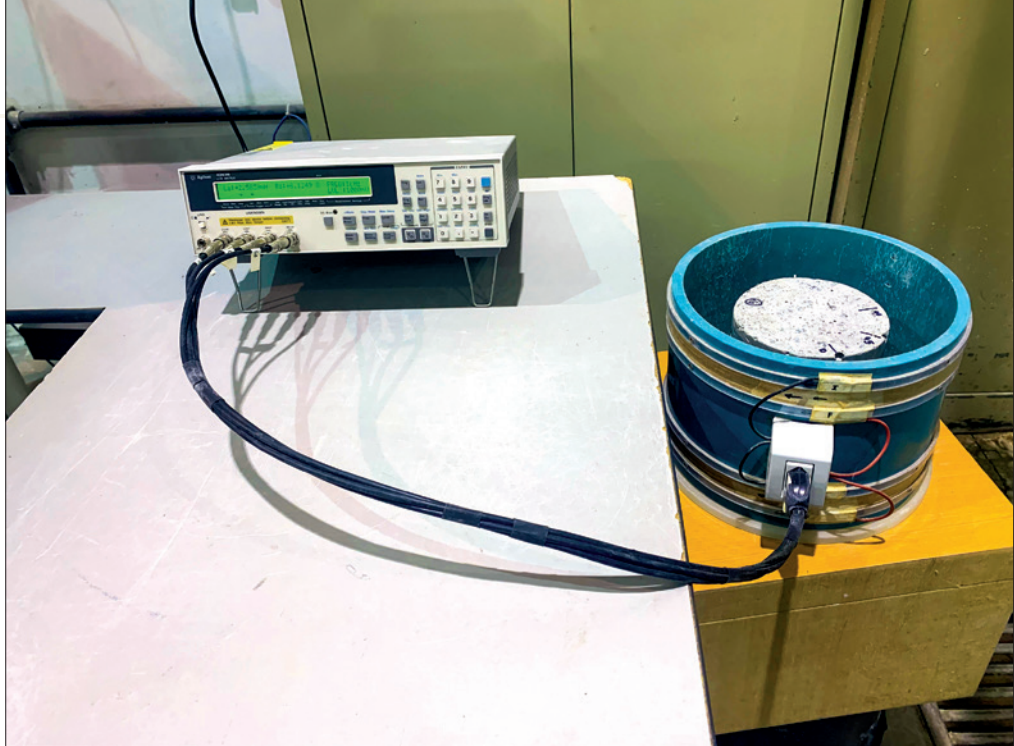
Ensaio indutivo em corpo de prova cilíndrico
