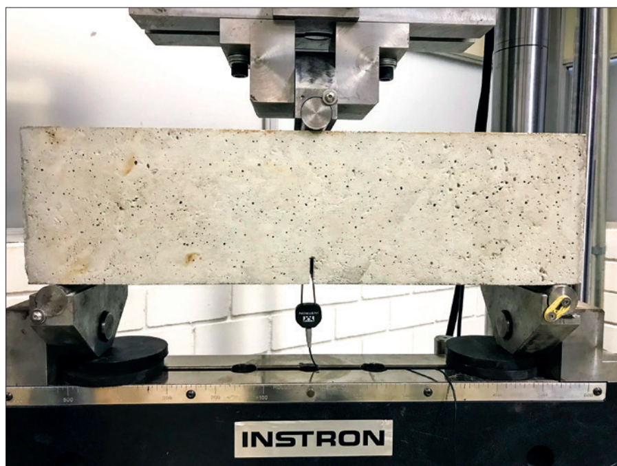
Ensaio de flexão em corpo de prova prismático com entalhe
