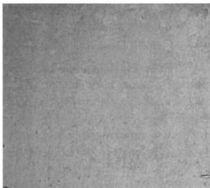
FIGURA 23.10 Aspecto de painéis pintados após três anos de exposição.
