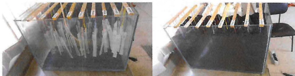
Figura 1 – aparato usado para realização do teste de biodegradação dos corpos de prova
