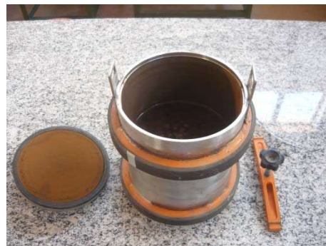
Figura 2 – Jarro com carga de corpos moedores e minério
