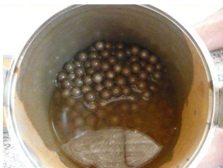
Figura 3 – Detalhe do jarro com carga de corpos moedores e minério
