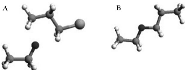
**Figura 4.** Orientação espacial das espécies envolvidas no processo  $S_N2$  estudado. A. Íon etóxido e conformero de menor energia do 1-cloro-propano(anti): aproximação do nucleófilo ao carbono  $\alpha$  ao cloro é impedida estericamente. B. Produto obtido: éter etilpropílico
