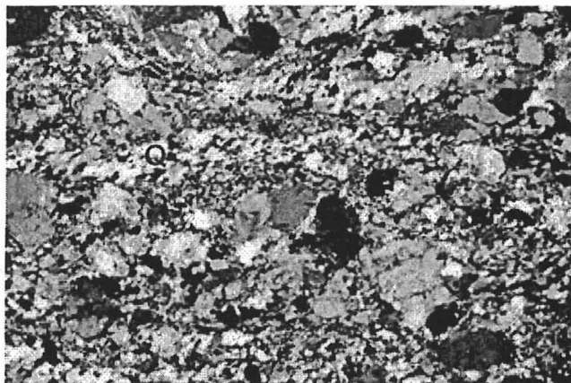
Figura 7 – Microtextura do agregado gráudo na qual se observam bolsões de quartzo recrystalizado (Q) e cristais de feldspato triturados e rotacionados circundados por quartzo microcristalino.
