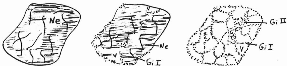
Fig.3 - Alteração da nefelina (Ne) V: Porosidade-Gi I e II: Gibbsita primária e secundária
