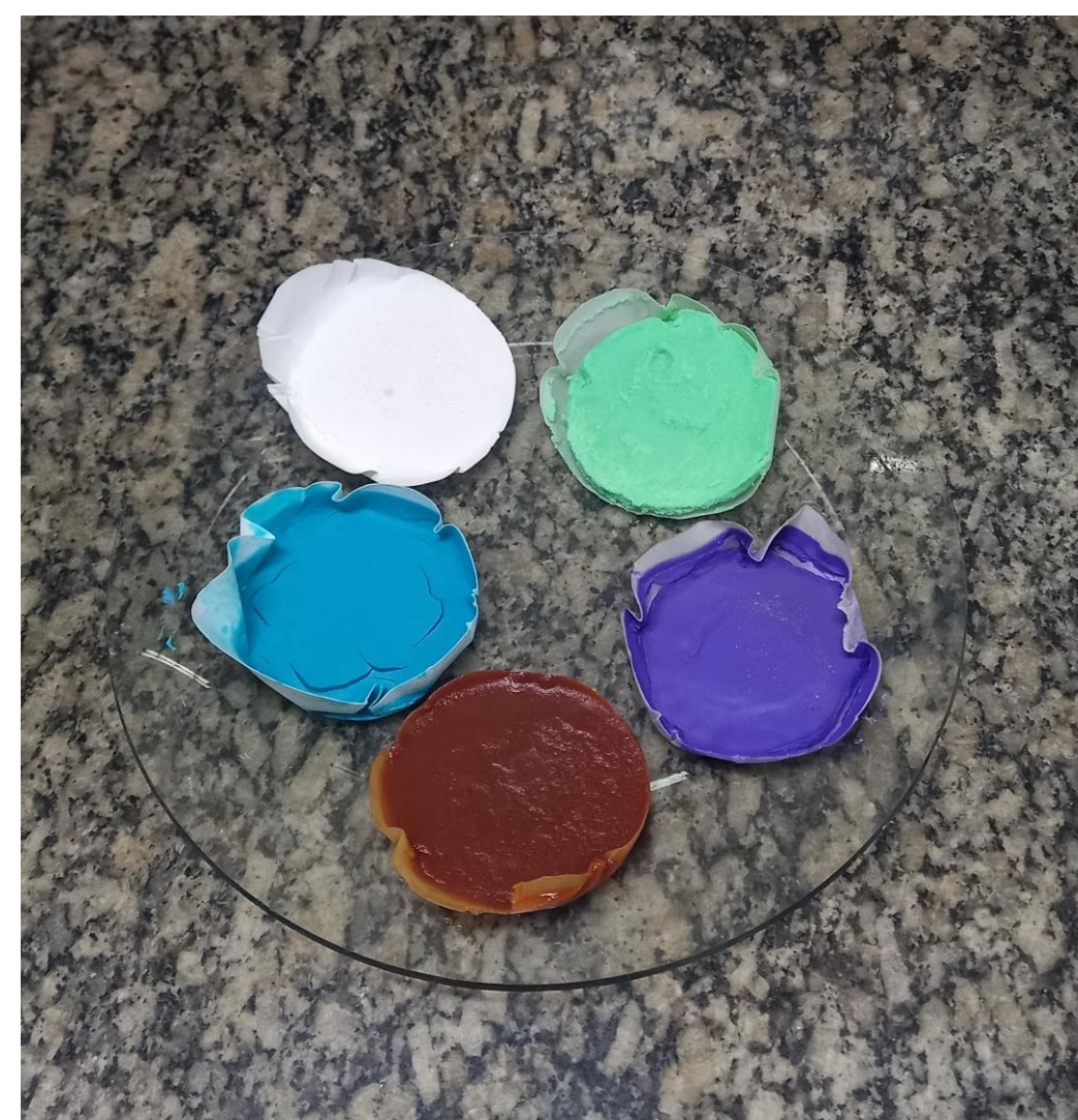
MOFs sintetizadas com diferentes metais e Ácido Tereftálico.
