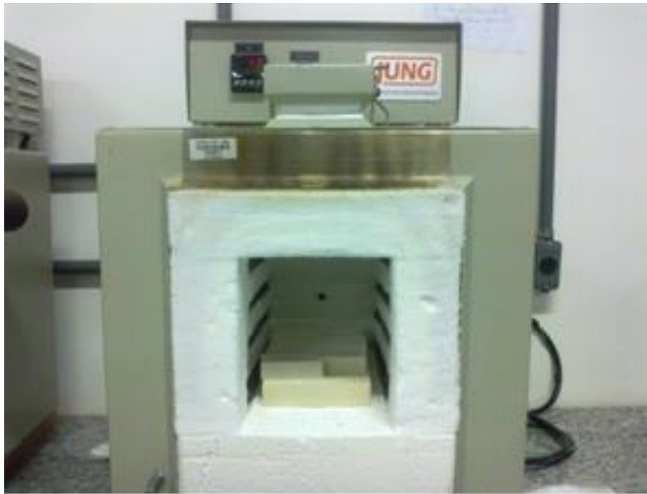
Figura 1. Mufla de sinterização com os corpos de prova.
