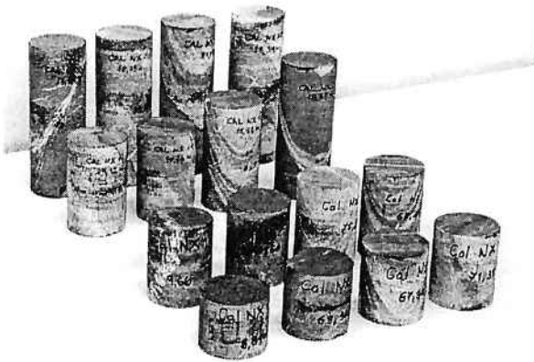
Figura 9 - Alguns corpos de prova NX
