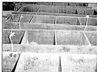
Fotografia 6 - Forma para molde dos CP
