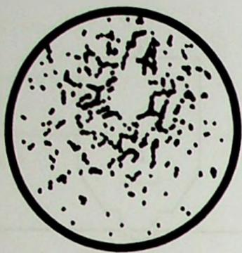
**FIGURA 22.26** Esquema do aspecto da desagregação entre os cristais em um ensaio de fadiga.
