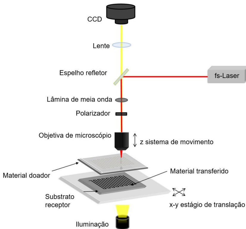
Figura 13.6 – Representação esquemática de um sistema LIFT usando laser de femtossegundos. Figura adaptada da referência. 31
