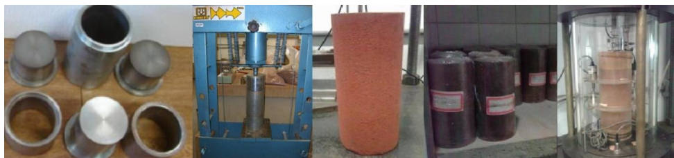
Figura 1: Etapas da moldagem e ensaio dos corpos-de-prova.
