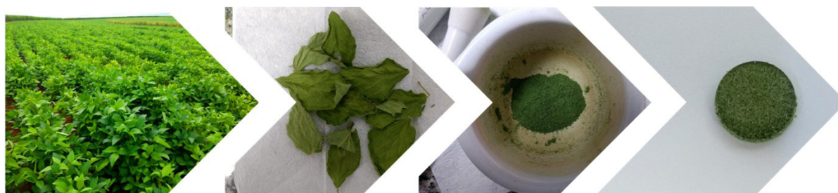
Figura 1. Processo de preparo da amostra para a técnica LIBS, desde a coleta das amostras no campo até o seu preparo no laboratório com almofariz e pistilo, resultando em uma pastilha.
