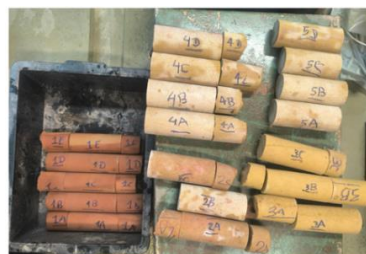
Figura 2: CPs de arenitos já dimensionados (topo e base) em serra diamantada. Fonte: Do Autor (2024).
