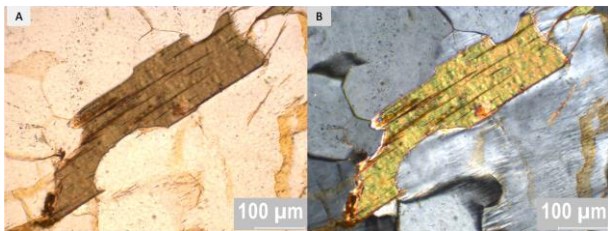
Figura 5. Fotomicrografia da amostra R28, apresentando Bt alterada para clorita com acúmulo de óx./hidrox. de ferro. Fissuramento relacionado a abertura do plano de clivagem.
