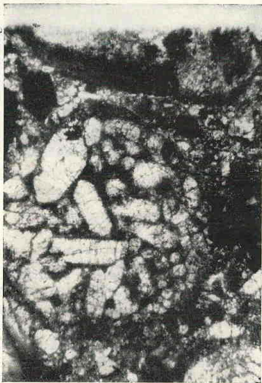
Fig. 4 — Fotomicrografia da seção delgada do meteorito, onde se observam cristais idiomorfos de olivina. Aumento de 31 vezes.
