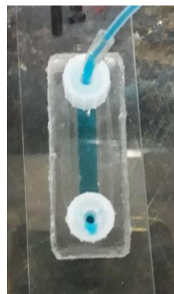
Figura 4. Chip construído de PDMS a partir de um molde obtido a partir de uma impressora 3D de resina.
