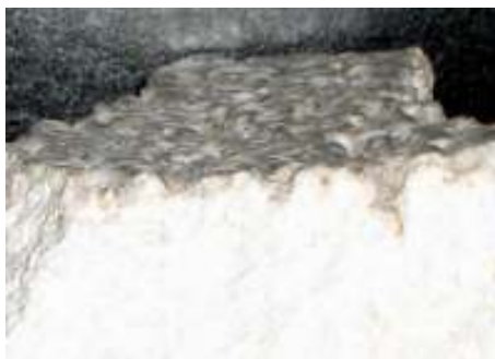
Figura 1 - Vista de um pedaço do cadinho atacado pelo vidro
