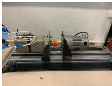
Figura 3: Máquina Siemens (esquerda) acoplada ao motor CC (direita).
