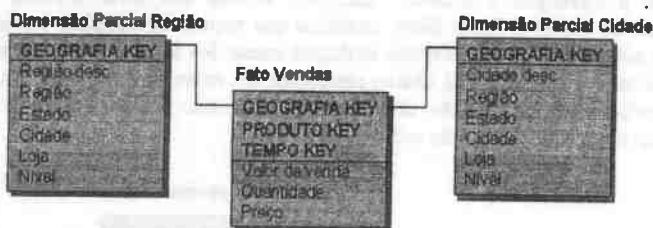
Figura 23 – Implementação do esquema Dimension Partitioning, representando o particionamento da tabela dimensão Geografia.
