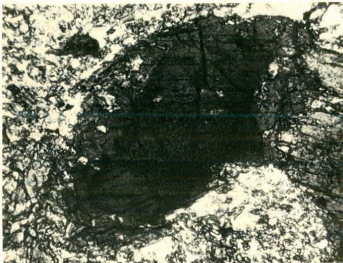
Fotomicrografia 2 — Núcleo de hornblenda I (castanha) cercado por hornblenda II (verde). Rocha oligoclásio-andesina anfíbolito. Nicóis descruzados. Aumento 200 ×
