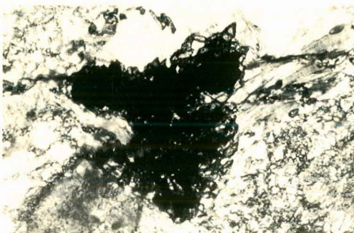
Fotomicrografia 1 — Cristal de ilmenita parcialmente transformado em titanita. Rocha albita anfibolito. Nícois des-cruzados. Aumento 200 ×
