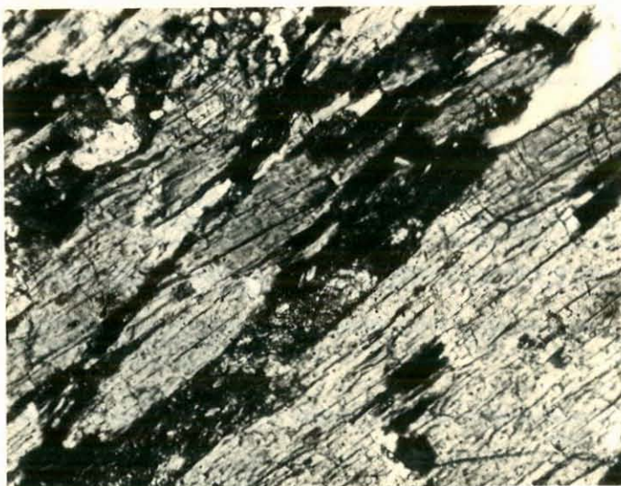
Fotomicrografia 5 — Hornblenda parcialmente transformada em clorita, titanita, epidoto. Rocha albita anfíbolito. Nícois descruzados. Aumento 300 x
