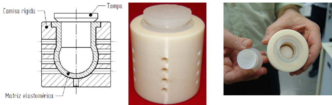
(a) (b) (c) Figura 3- Molde para prensagem das esferas, em a) vista em corte; em b) molde carregado com o pó e fechado e em c) esfera recém-prensada dentro do molde.
