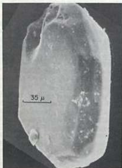
Fig. 2 - Olivina prismática bituminada exibindo cavidades elipsoidais.
