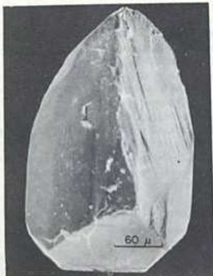
Fig. 8 — Diopsídio exibindo faces simétricas em relação ao plano ac normal à figura.
