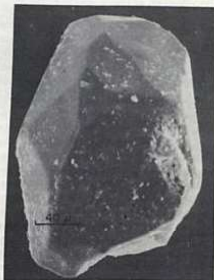
Fig. 6 - Enstatita prismática constituída pela combinação de várias formas simples.
