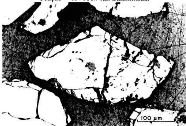
Figura 1. Grão de cassiterita com inclusões de silicatos e columbita-tantalita – Fração – 48+100# luz transmitida.
